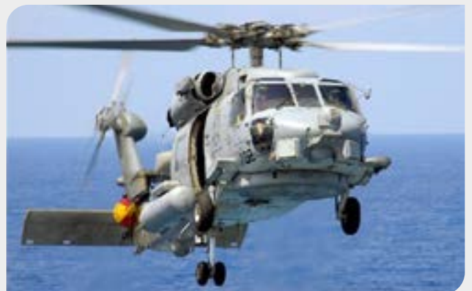
画像 2: EOシステムを前面に装備したヘリコプター。クレジット: U. S. Navy Mass Communications Specialist 3rd class James Vasquez
