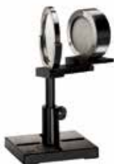
ビームスプリッター（スプリッター装着時） 反射光がセンサーに入射
