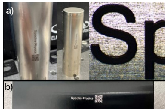
図5. a)は、バッテリーパック上のブラックマーキング。b)は、アルマイト処理アルミニウムのホワイトマーキング。
