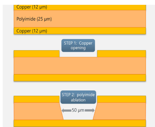
図1. 一般的なフレックスPCBのCu/PI/Cu積層構造に対するブラインドビア穴あけ加工の2つの工程を図示した様子。
